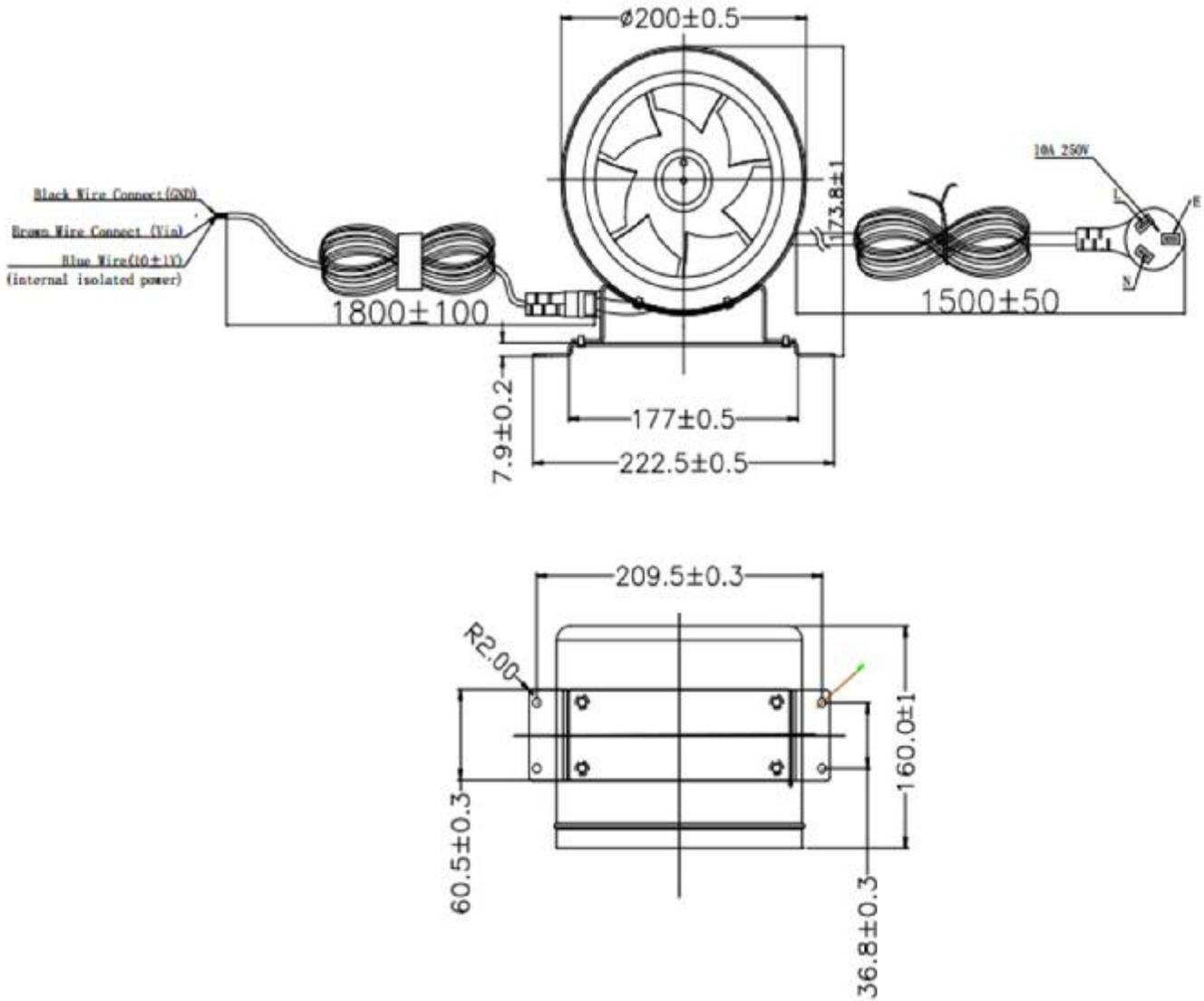
接线说明:黑线接地(GND),棕线接电压变化端,蓝线输出隔离电源:10V±1V
